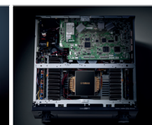
Châssis transversal rigide en H et Disposition symétrique des amplificateurs de puissance
