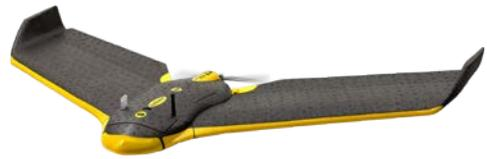
Hyper-légers, d'une envergure de moins d'un mètre et avec une autonomie de 30 à 45 minutes selon le modèle, ce sont plus d'une soixantaine de drones civils professionnels senseFly qui sont fabriqués et vendus chaque mois, avec la cartographie de précision pour principal usage.
