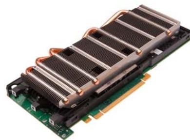
Équipé de 512 coeurs® CUDA de traitement en parallèle, le GPU Tesla 2090 offre 665 gigaflops de performances double précision en pic, conduisant à une accélération des applications jusqu'à 10 fois supérieure à celle fournie par un seul CPU.
