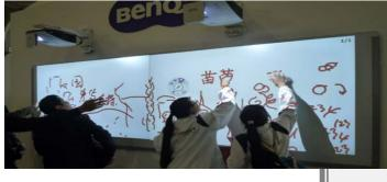
Pour disposer de cette option et ainsi pallier à l'éventualité de manquer de stylets, il suffit de positionner le boitier dit « rideau laser » au-dessus et au centre de la surface de l'écran.
