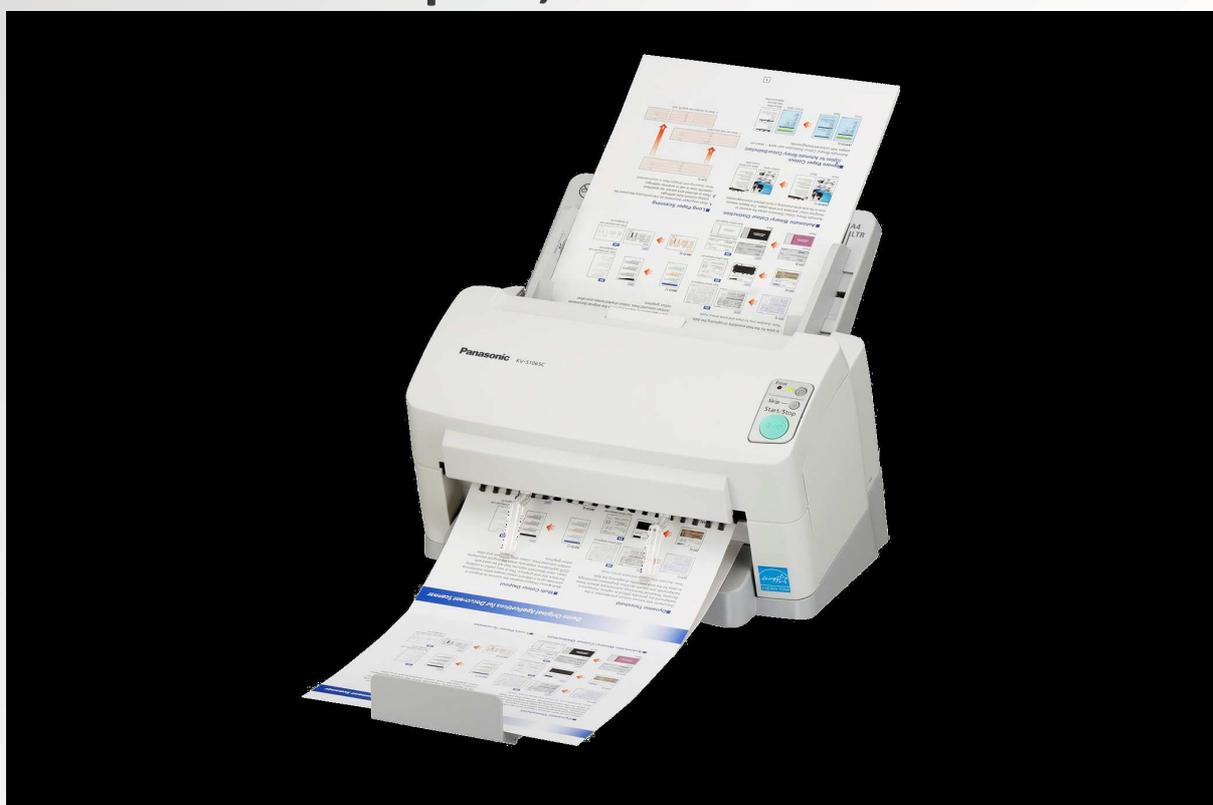
Capable de s'insérer dans des endroits exigus, le KV-S1065C numérise jusqu'à 60 pages par minute. Il peut également traiter des documents d'épaisseur très fine et détecte les images qui nécessitent une nouvelle numérisation
