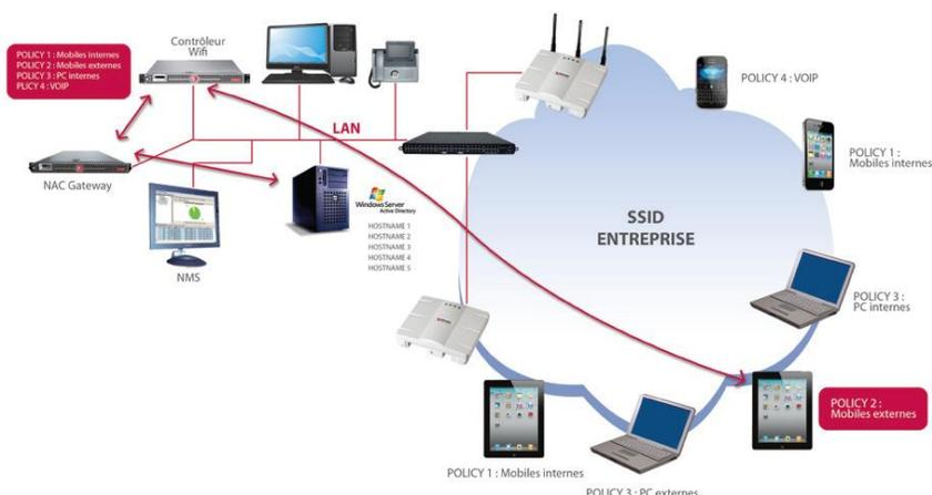
Dans une approche classique, **la mise en œuvre d'un réseau sans fil pour connecter les terminaux mobiles de types portables ou téléphones Wi-Fi, repose sur la création de plusieurs SSID**. Chacun avec un usage bien déterminé et une sécurité qui lui est propre, **ce qui implique de nouvelles contraintes de configuration et d'administration**.
