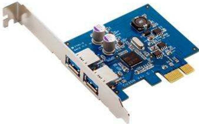
La CU30N est une carte additionnelle PCIe qui est compatible avec les ports **PCI Express x1, x4, x8 et x16**. L'installation de la carte est aisée et **elle ne nécessite pas d'alimentation électrique externe** pour fonctionner. Une fois installée, la carte CU30N offre à votre système **deux ports USB 3.0** pour ainsi vous permettre de connecter tous vos matériels USB 3.0.
