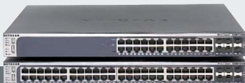
Côté Tête de réseau, la pile de trois commutateurs de cœur de réseau est connectée à sept sous répartiteurs via une liaison Uplink de 4 Gbit/sec. Pour deux des commutateurs, il s'agit de ports SFP fibre Gigabit Ethernet. Pour le troisième, utilisé en backup, il s'agit de ports RJ45 Gigabit Ethernet. Tous les liens sont redondants à l'intérieur de la pile.
