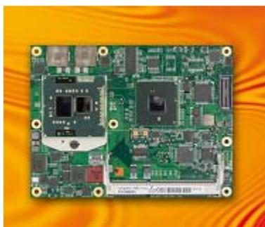
*Le Conga-BM57, un module au facteur de forme basique (95x125 mm) type II, offre un maximum de puissance de calcul avec les plus hautes performances graphiques du marché provenant d'un contrôleur intégré.*
